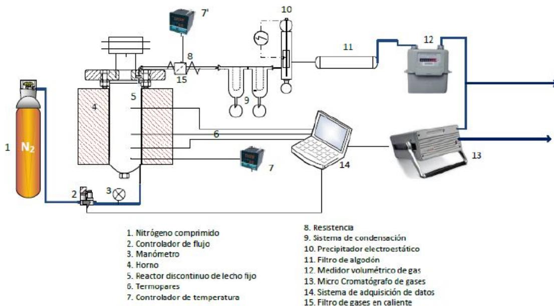
**Figura 4. Esquema de la instalación experimental de pirólisis**
