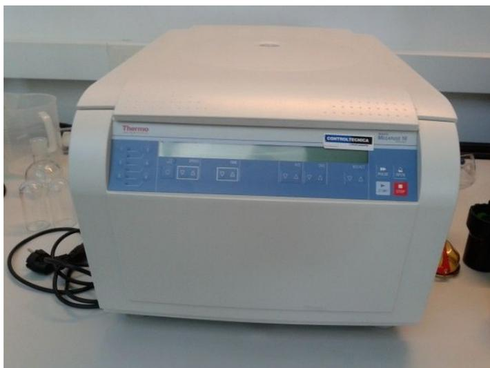
**Figura 5. Centrífuga empleada para la separación de fases**
