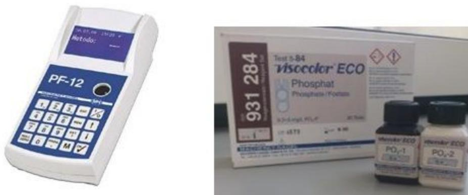
**Figura 3. Fotómetro y kit empleado para la medición de fosfatos**
