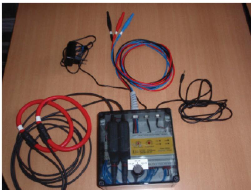
*Figura 6. Equipamiento medición potencia consumida.
