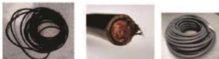
*Figura 7. Cable de sección 40 mm<sup>2</sup> y tubo de poliamida*
