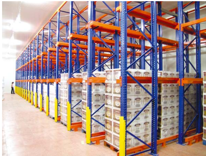
Figura 2-2 Sistema de almacenamiento compacto
