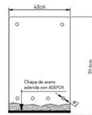
**Sistema 3:** Adhesión MBrace LAMINATE (3 Laminados 170/3100 100x1,4)
