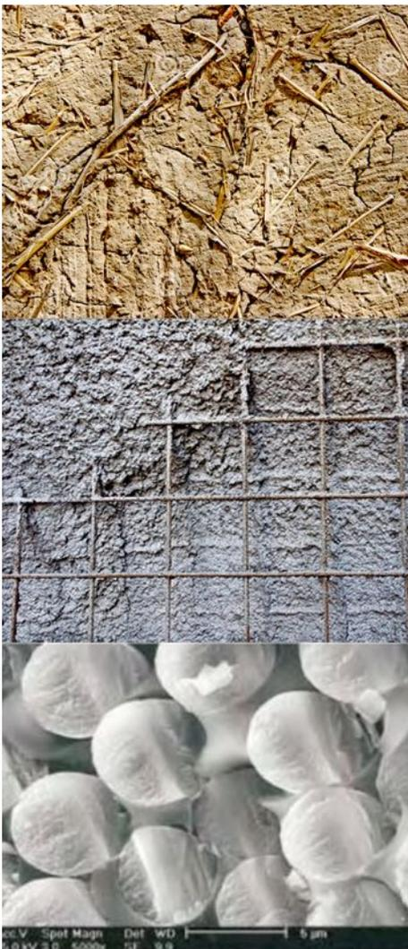
Imágenes de la estructura del adobe, el hormigón armado y microestructura de frp
