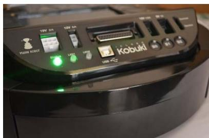
Figura 35. Conexiones de la base del TurtleBot (Kobuki base).
