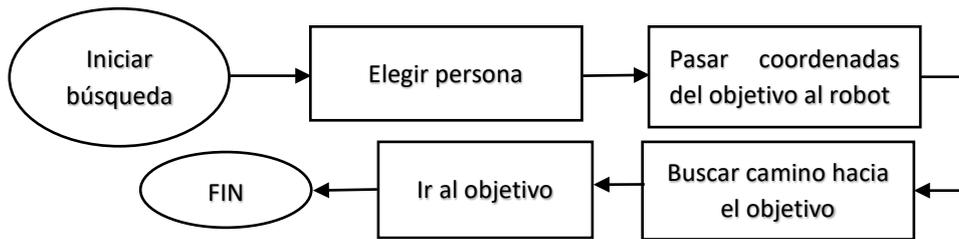
Figura 27. Diagrama de bloques explicativo del método usado en los primeros experimentos con el sistema completo.
