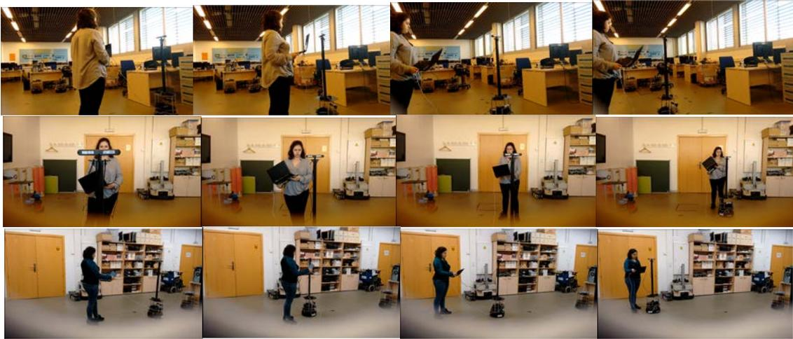
Figura 63. Cada línea corresponde con un experimento en el que se ha realizado un reconocimiento y acercamiento iterativo. En la primera imagen se muestra la posición inicial de la persona y el robot en el experimento, a continuación, dos posiciones intermedias en las que el robot se ha acercado poco a poco a la persona y por último las posiciones finales en el experimento.
