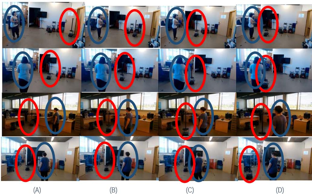
Figura 28. Imágenes de cuatro experimentos, uno en cada línea siguiendo el siguiente orden (Prueba1, Prueba 3, Prueba 4 y Prueba 8). Se usan tres escenarios: escenario 1: fila 1, escenario 2: fila 2 y 4 y escenario 3: fila 3. En cada experimento se puede ver la posición inicial del robot en rojo y la persona en azul (A), en medio imágenes intermedias en las que el robot se acerca a la persona (B), (C) y al final la posición en la que acaban el robot y la persona (D).
