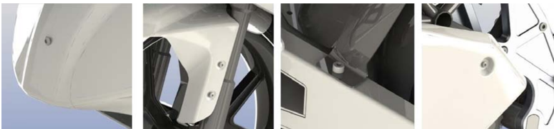
Fig. 44: Detalles de las uniones del carenado con el chasis
