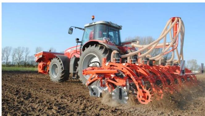
Figura 44: Vista del Striger equipado con el kit de fertilización mineral y unido a una tolva delantera.
