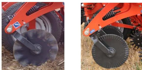
Figura 36: Diferencia entre los dos discos abridores que se pueden montar en el Striger: disco ondulado (izqda.) y disco escotado (dcha.).
