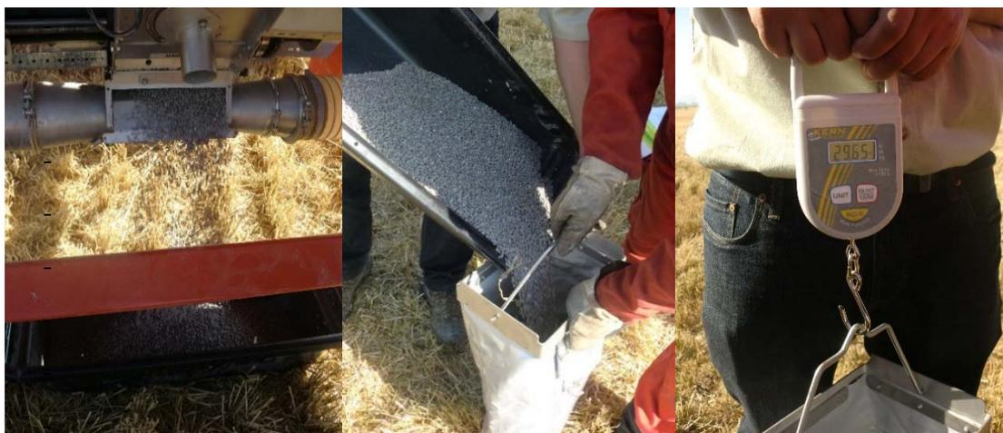
Figura 59, 60, 61: Proceso de calibración del dosificador para distribuir el flujo de abono necesario para conseguir la dosis deseada.
