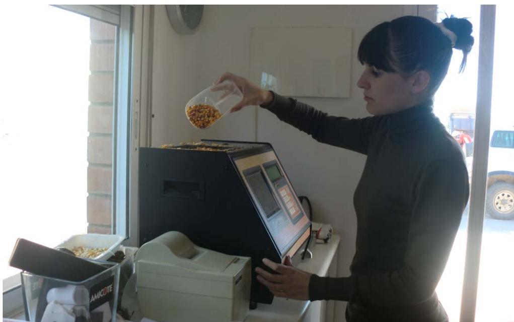
Figura 74: Análisis de las muestras de maíz grano recogidas en el remolque, mediante el ordenador de análisis de grano.
