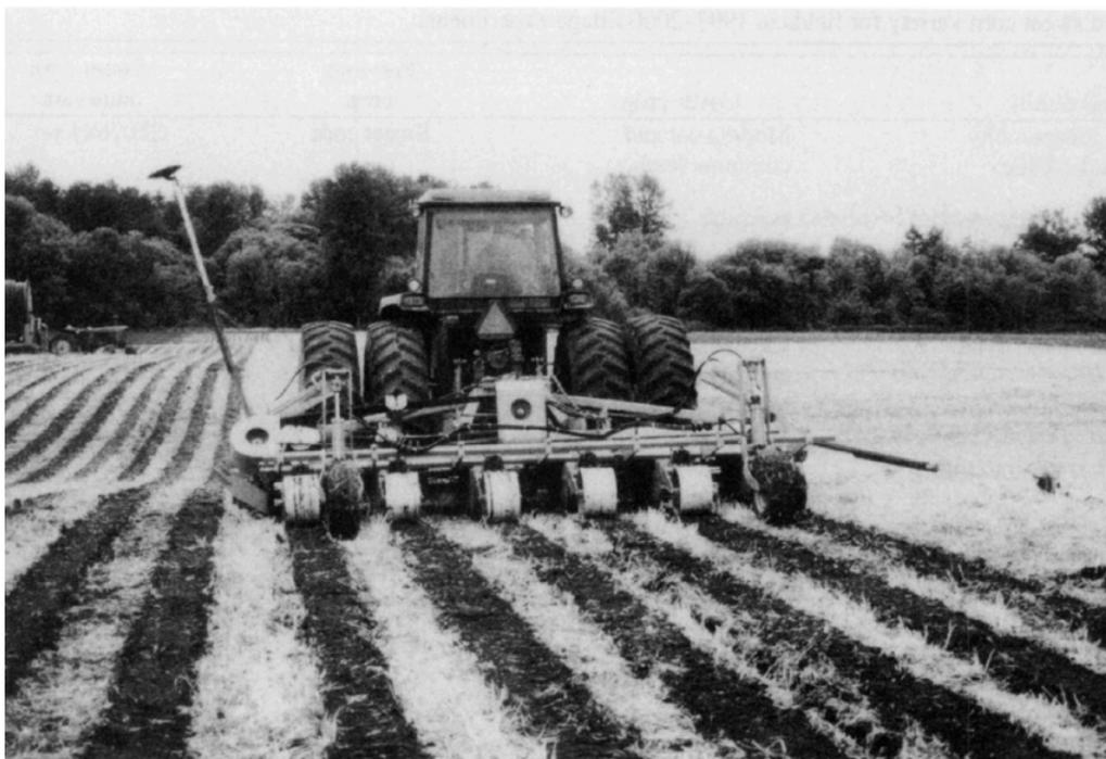
Figura 1: Apero Strip-Till rotativo usado en unos experimentos entre 1997 y 1998, configurado para 6 líneas de 20 cm de anchura con una separación de 75 cm.
