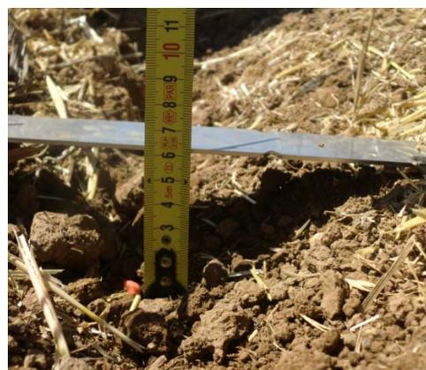
Figura 53 y 54: Algunos ejemplos de la medición de la profundidad de siembra en campo (6,2 cm en primer y segundo ensayo respectivamente).
