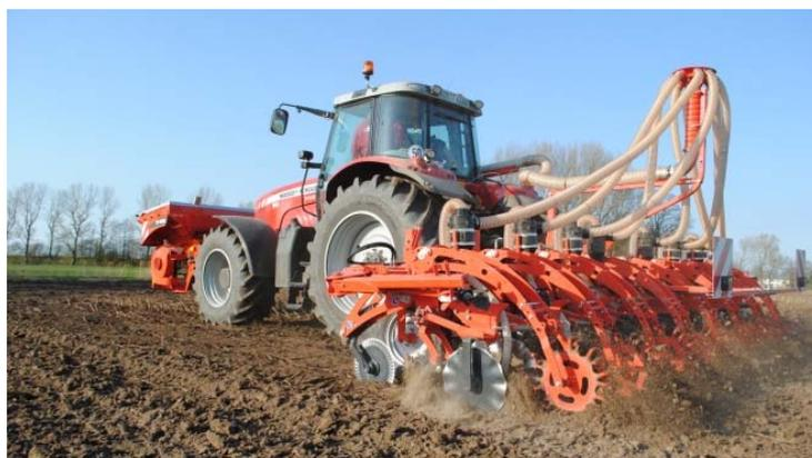
Figura 24: Imagen del Striger con el kit de abonado mineral localizado (KUHNN).
