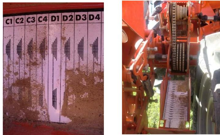
Figura 49: Posición de la cadena en los engranajes Regulación de la MAXIMA 2 en la posición D1 para conseguir la dosis de siembra deseada.
