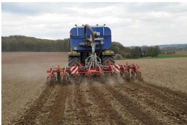
Figura 45: Vista trasera de una cisterna esparcidora de purines equipada con el Striger.
