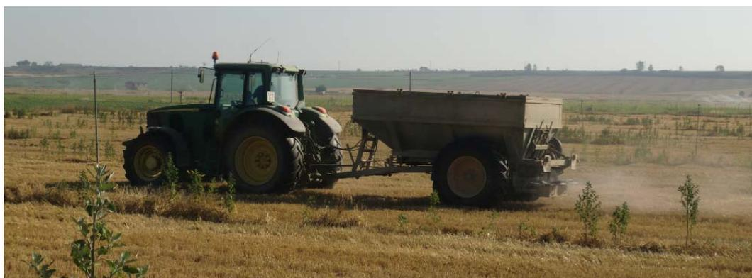
Figura 64: Conjunto JD 6820 + abonadora Coorepa en el trabajo de distribución de abono en superficie.
