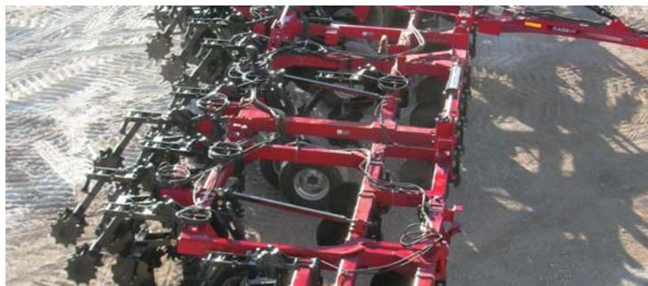
Figura 9: Modelo de apero de laboreo en bandas de la marca CASE® para América del Norte: Nutri-tiller 950.
