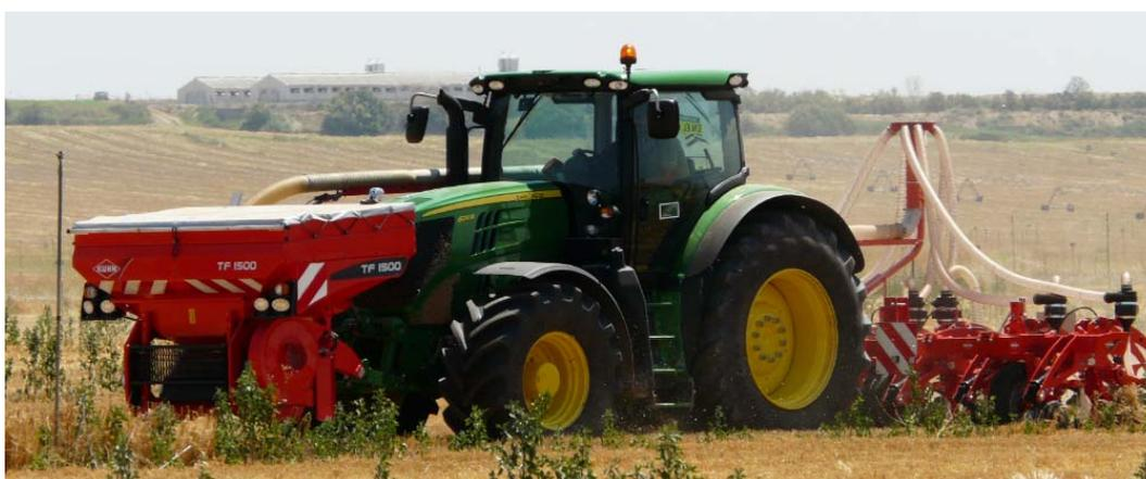
Figura 57: Conjunto formado por TF 1500 + JD 6210 R + STRIGER 8R + kit de Fertilización (columna + ciclón + cabezal de distribución + diente adaptado)
