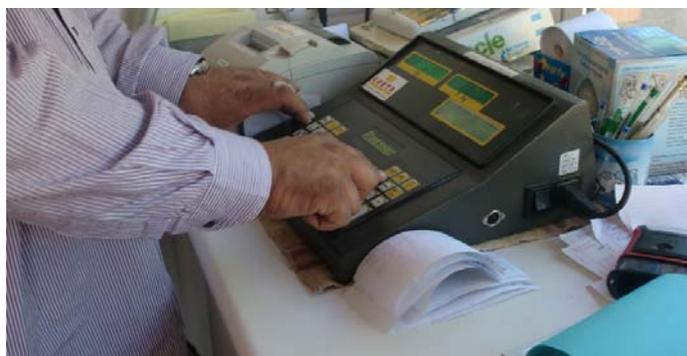
Figura 73: Monitor que gestiona la báscula de pesaje en el momento de la pesada del tractor con el remolque y el grano cosechado.
