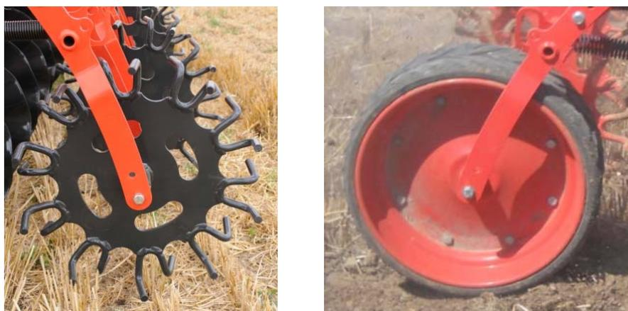
Figura 40: Diferencia entre los dos ruedas de compactación con las que se puede equipar el Striger: rueda de dedos metálicos (izqda.) y rueda OTICO con recubrimiento de caucho (derecha).
