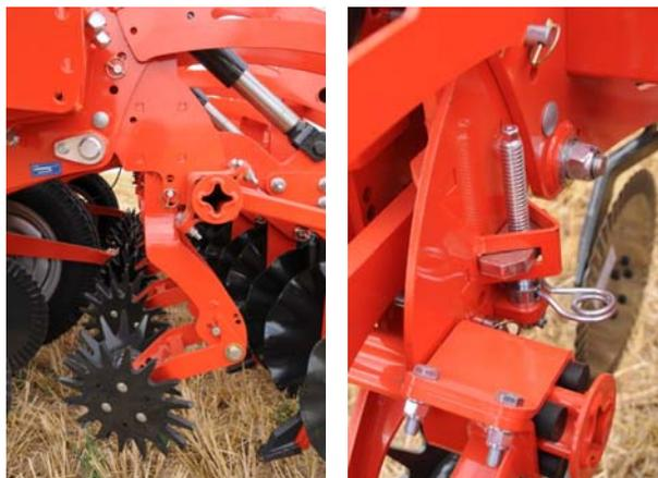
Figura 37: Vista lateral del disco aparta-residuos (izqda.) y detalle de la regulación en altura de estos discos estrellados (dcha.).
