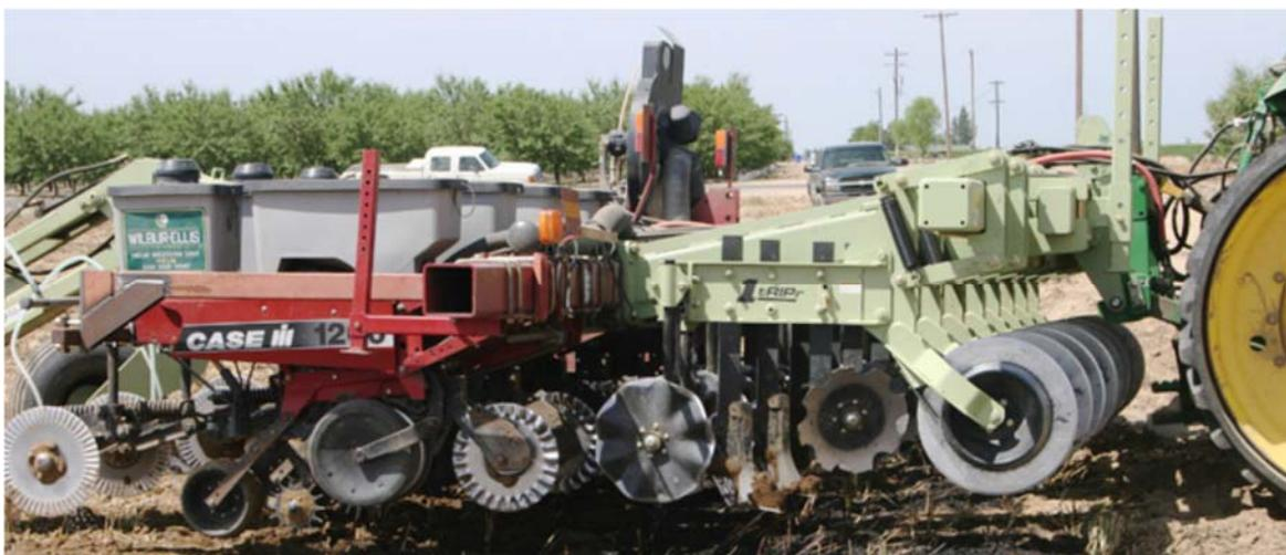
Figura 13: Modelo del apero de laboreo en bandas de Orthman, 1 tRIPradiator, al que se le ha acoplado una sembradora de CASE para realizar el laboreo en bandas y la siembra en una pasada, Kerman, California, 2006. Foto: Jeff Mitchell
