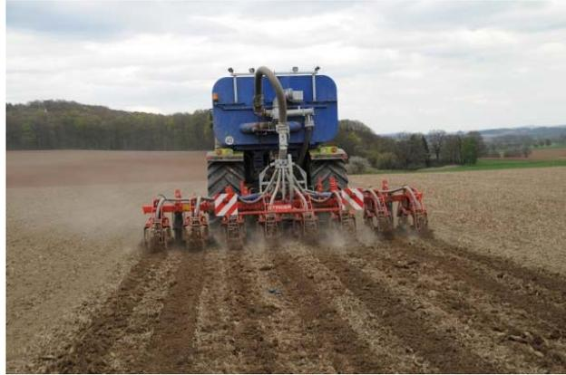
Figura 25: Imagen del Striger acoplado tras una cisterna de purín para inyectar el abono orgánico en la banda de trabajo del Striger.
