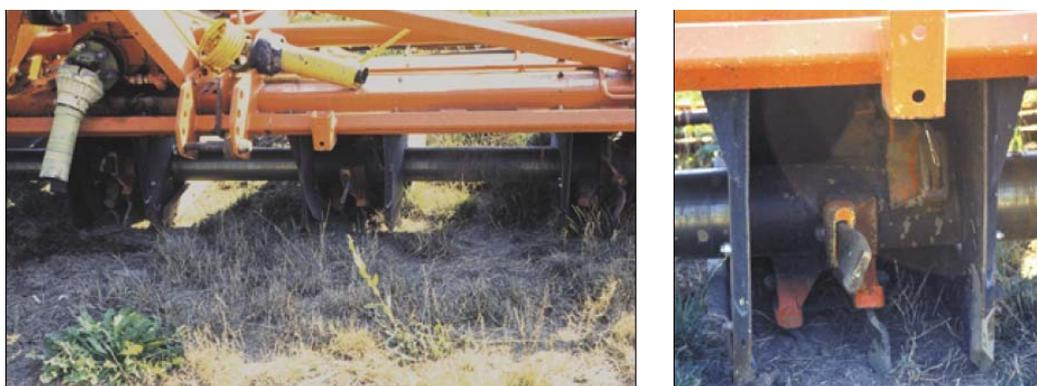
Figura 5 y 6: Fresadora de Howard modelo Rotospike® para realizar el sistema de laboreo en bandas.
