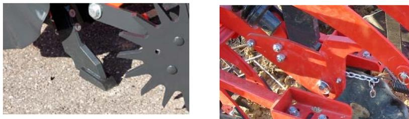
Figura 38: Detalle de la punta de la reja (izqda.) y regulación de la profundidad de trabajo del Striger (dcha.).
