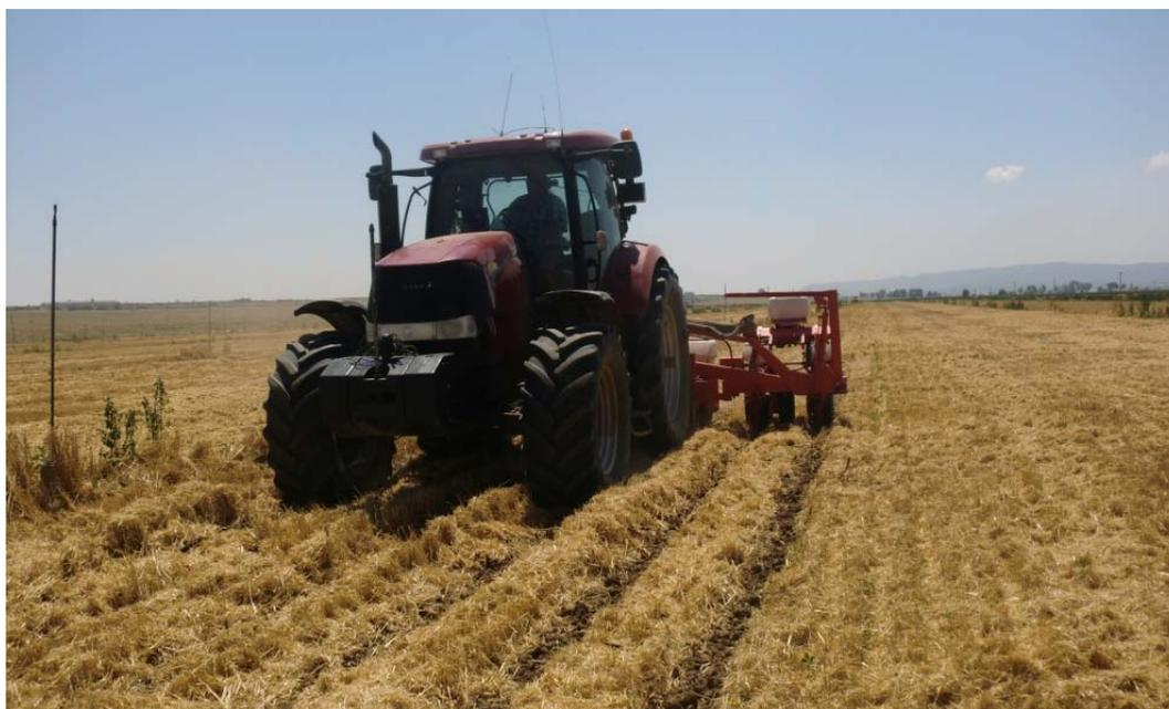
Figura 21: Siembra de maíz sobre la línea preparada por el STRIGER en rastrojo de cebada. A la derecha podemos observar el campo sin trabajar y la cantidad de restos vegetales de cebada en superficie.
