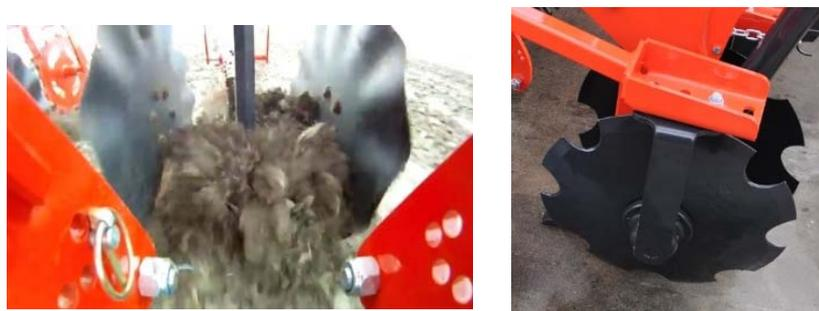
Figura 39: Diferencia entre los dos discos deflectores que se pueden montar en el Striger: disco ondulado (izqda.) y disco dentado (dcha.).
