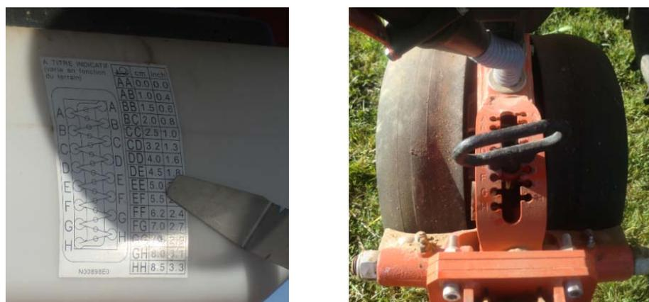
Figura 50: Información del fabricante acerca de la regulación de la máquina para conseguir una profundidad de siembra deseada (puede variar en función del terreno).
