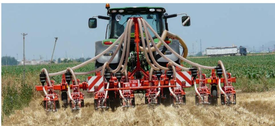
Figura 58: Vista de la parte trasera del cabezal de distribución y de cada una de las salidas que desemboca en un ciclón.
