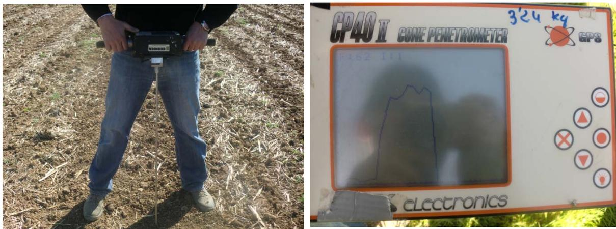
Figura 76 y 77: La imagen de arriba a la izquierda muestra la forma de uso del Penetrómetro en campo, en posición inicial. En la imagen de la derecha podemos observar el cabezal del Penetrómetro CP40 II en el momento de toma de datos.
