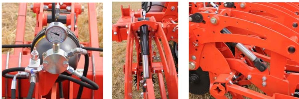
Figura 41, 42 y 43: Distintas vistas de la reja de laboreo: detalle del acumulador de nitrógeno y del manómetro de regulación para ajustar la presión de la seguridad hidráulica de cada reja en trabajo (imagen de la izquierda). Vista trasera (imagen del centro) y lateral (derecha) del vástago.
