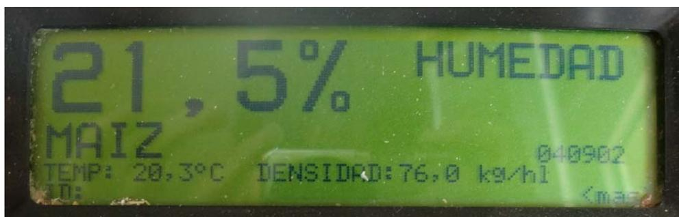
Figura 75: Pantalla del ordenador de análisis de grano en el que se observa la información dada para una muestra.
