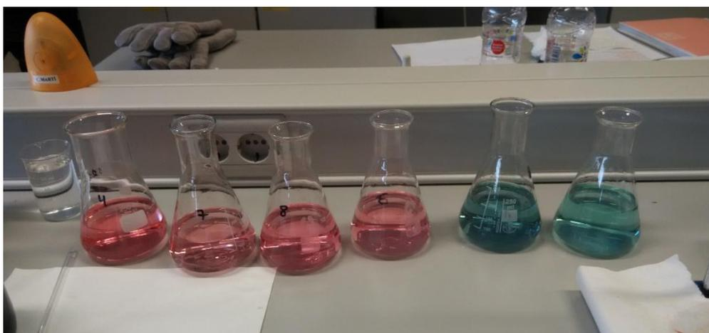
Figura 17. Determinación del nitrógeno kjeldahl total
