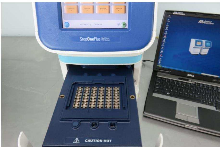
**Figura 7.** Hardware utilizado StepOne Plus con placas de 96 pocillos.
