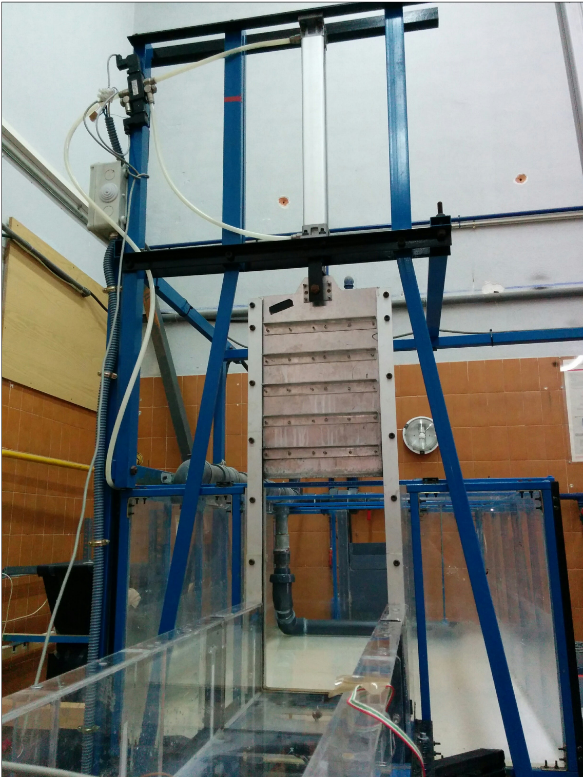
Figura 3.2: Compuerta del canal.
