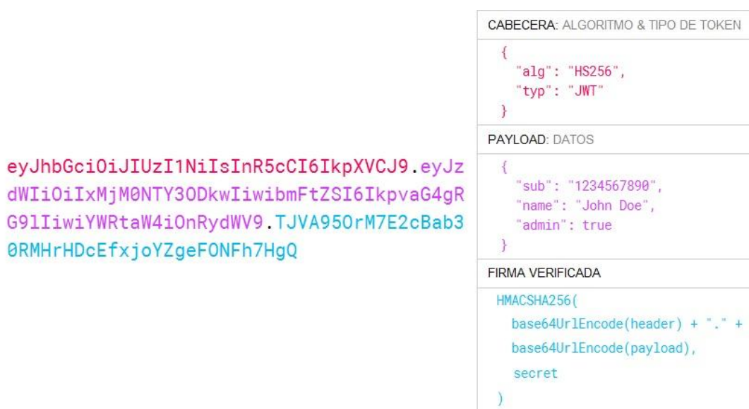
Figura 12. Estructura de un JSON Web Token
