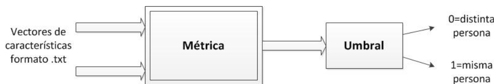
Figura 3.13: Proceso de comparación y reconocimiento implementado en este sistema.
