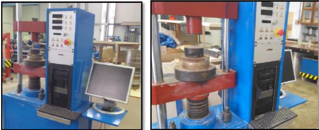
Figura 7. Maquinaria empleada para la realización de los ensayos de compresión de las estructuras porosas.
