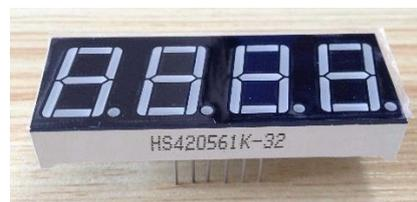
Figura 14. Visualizadores de 7 segmentos. A la izquierda de un dígito y a la derecha de 4 dígitos.
