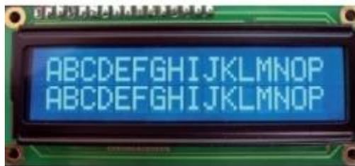
Figura 13. Pantalla LCD de 2 filas de 16 caracteres
