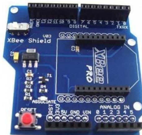
Figura 19. Arduino XBee Shield
