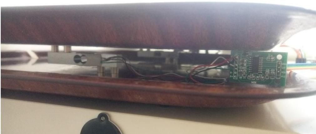
Figura 27. Fotografía del montaje de las básculas y el HX711
