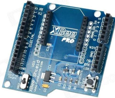
Figura 35. El jumper para cambiar entre modo XBee y modo USB se puede observar en la esquina inferior izquierda
