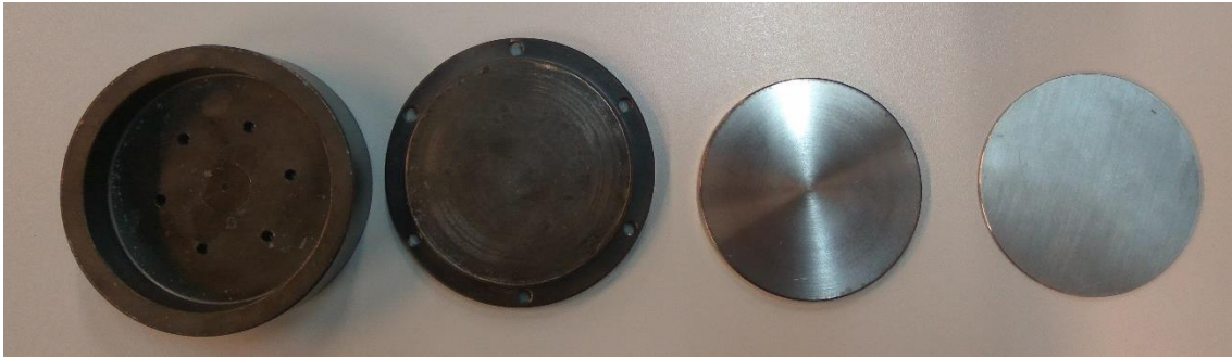
Figura 8: Molde utilizado en la obtención de los discos “maestros” de \varnothing 90 mm y espesor 4 mm
