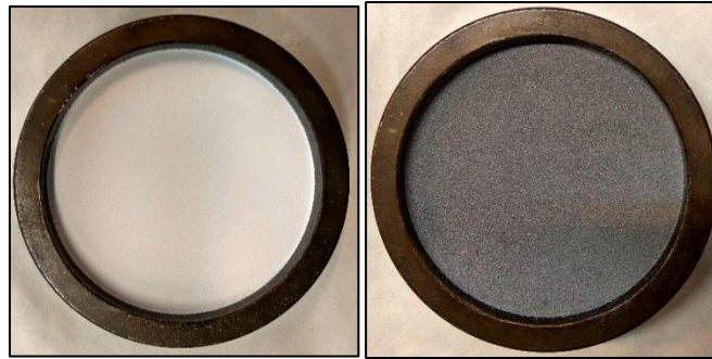
Figura 6: Molde con el material PEUAPM (izquierda) y capa de grafeno/PEUAPM (derecha) sobre el material anterior
