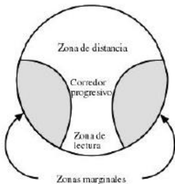
Figura 5: Esquema de zonas ópticamente útiles en una lente progresiva
