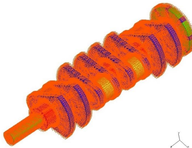
Figura 40 - Temperatura aplicada al cigüeñal
