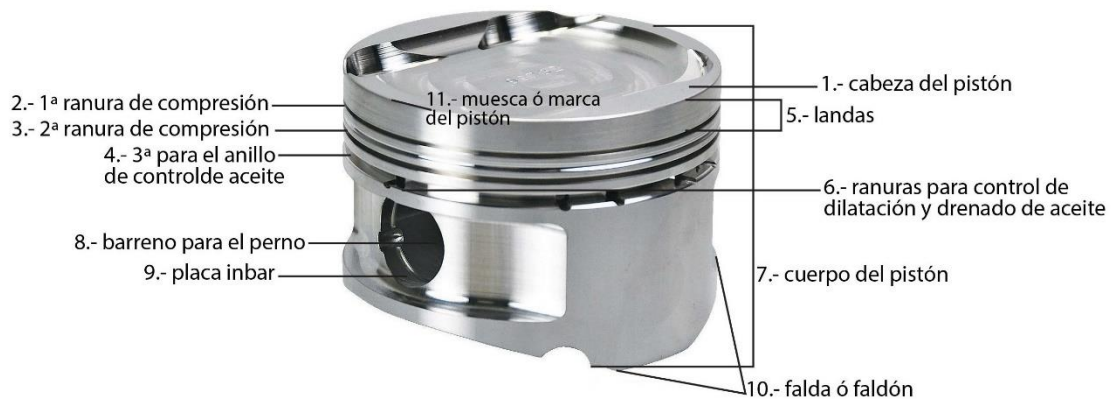
Figura 29 - Partes del pistón
