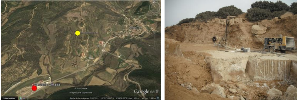
Imagen 4. Izquierda : en rojo localización del taller cantera (al SW de la imagen) y en amarillo el frente activo (en la zona central de la imagen y a la izquierda del casco urbano). Derecha : frente activo con el nivel explotado de arenisca y justo encima un máquina de testigos junto a un alimentador de gasoil.
