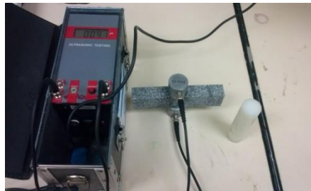
Imagen 10: Aparato de ultrasonidos en funcionamiento y badajo sintético estandarizado.
