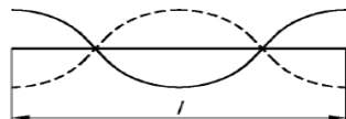
Imagen 1. Esquema del movimiento de vibración de una onda con longitud (l) cualquiera donde los 2 puntos sin oscilación representan a los nodos y las zona de máxima oscilación, en el centro y los extremos, representa el antinodo o panza de la onda.
