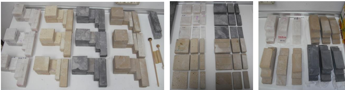
Imagen 2. A la izquierda las probetas principales talladas en primera instancia y que usaremos para el Método 2. Al centro probetas secundarias para estudiar la anchura mediante los ensayos fft y a la derecha las probetas secundarias para estudiar la longitud mediante los ensayos fft .
