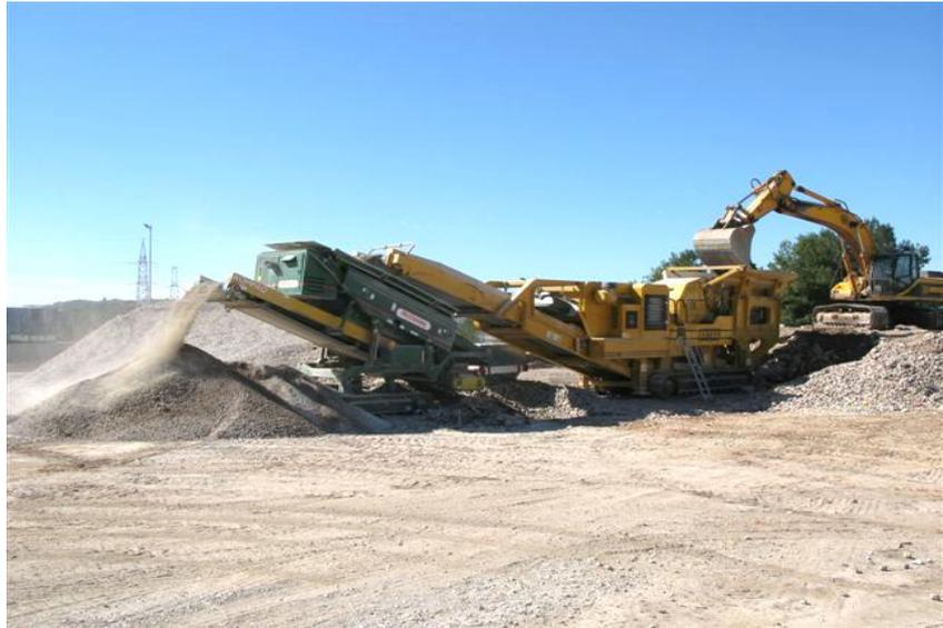
Figura 4: Planta de machaqueo para la producción de áridos reciclados.
