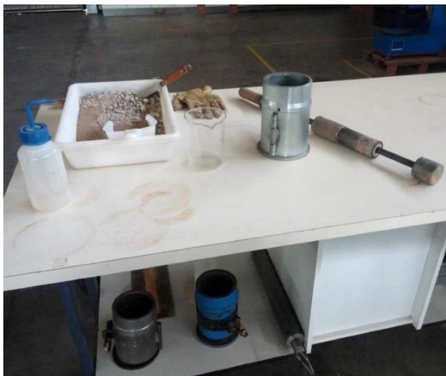
Figura 5: Material empleado para el ensayo Proctor.
