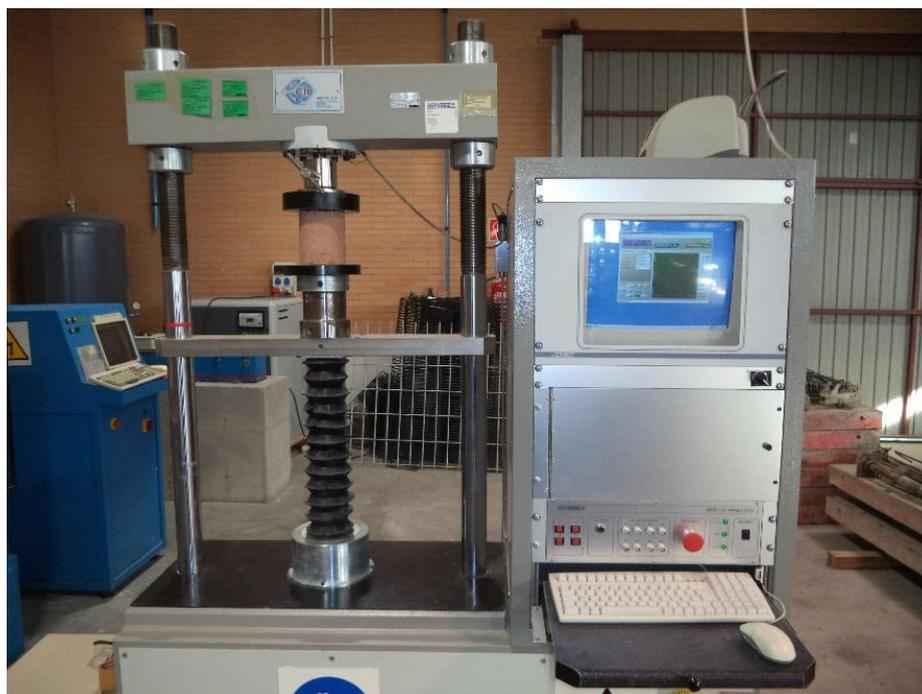
Figura 6: Prensa para ensayos a compresión simple del laboratorio de materiales de la EUPLA.
