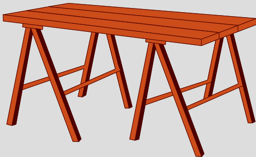
Andamio de borriquetas
