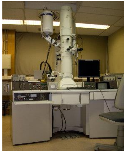
Figura 6: Microscopio electrónico de transmisión en el que se realizó el estudio.
