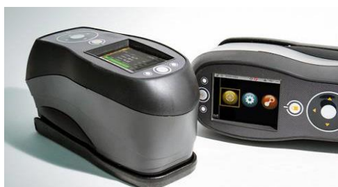
Figura 3: Espectrofotómetro utilizado para medir el color de las probetas.
