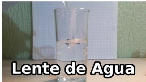
Al rellenar con agua este vaso curvo, debido al distinto índice de refracción del agua, actúa como una lente convergente. Nos permitirá ver la imagen ampliada de una flecha en un papel detrás del vaso ( si está entre el punto focal y el vaso el papel) o la imagen de la flecha invertida ( si el papel está más lejos que el punto focal de nuestra lente casera).
