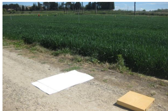
Figura 6. Spectralon y teflón el día del vuelo
