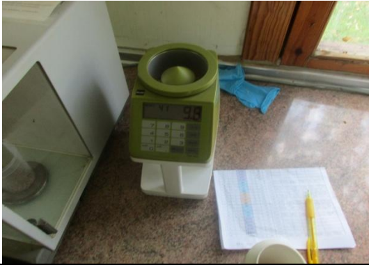
Figura 18. Obtención de humedad de la cosecha y del peso hectolitro con PM-600 (Keller)
