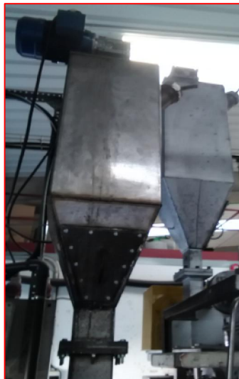
Figura 23. Tolvas de alimentación de materias primas de la planta piloto utilizada para llevar a cabo el proceso de pirólisis de biomasa y NFU.
