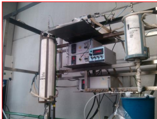
Figura 31. Instalación equipada con un reactor de lecho fijo utilizada para llevar a cabo el proceso de craqueo catalítico de los vapores del bioaceite .
