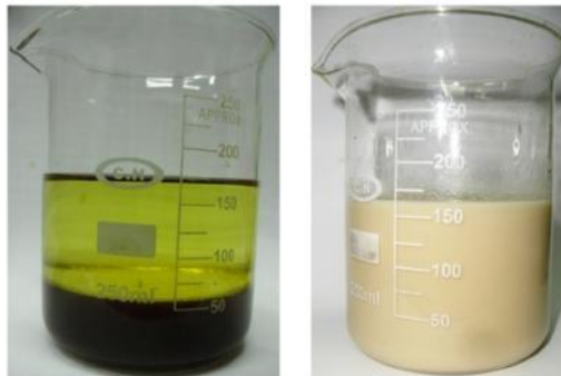
Figura 9. Diferencias entre la mezcla física de bioaceite y diésel (izquierda) y la mezcla bioaceite y diésel a través de un agente emulsificador (derecha).
