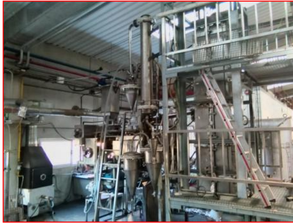
Figura 29. Planta piloto equipada con un reactor de lecho fluidizado utilizada para llevar a cabo los procesos de pirólisis y combustión.
