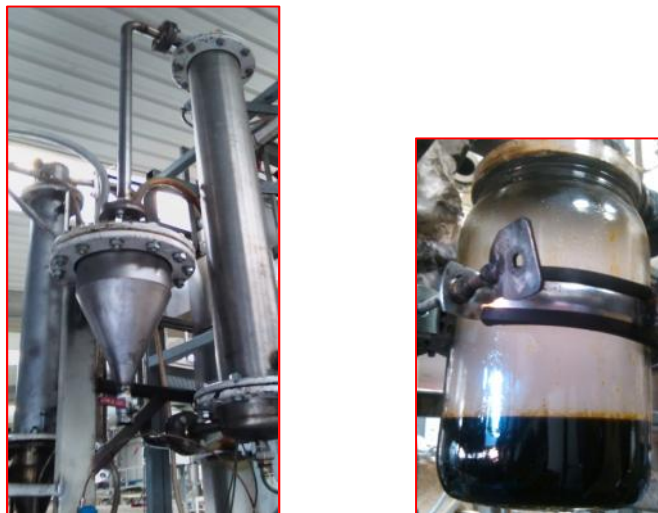
Figura 26. Condensadores (izquierda) y depósito de recogida del bioaceite (derecha) de la planta piloto utilizada para llevar a cabo el proceso de pirólisis de biomasa y NFU.
