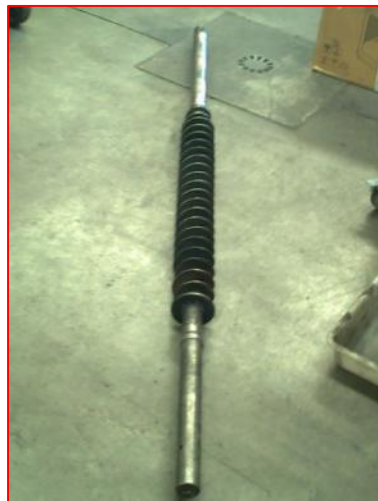
Figura 25. Tornillo sin fin del reactor de la planta piloto utilizada para llevar a cabo el proceso de pirólisis de biomasa y NFU.
