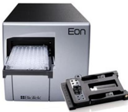
*Espectrofotómetro de microplacas termostatzado*
