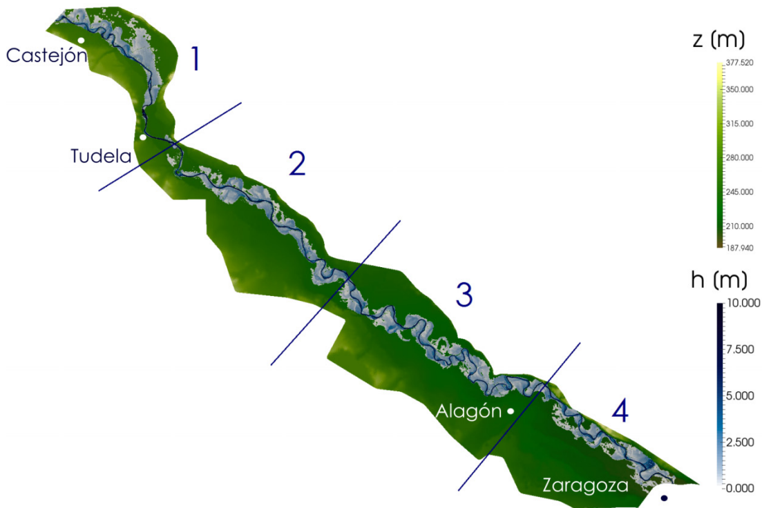
Figura E.37: Visión general de la extensión de la lámina de inundación para la avenida de 2003 en t=126 h.
