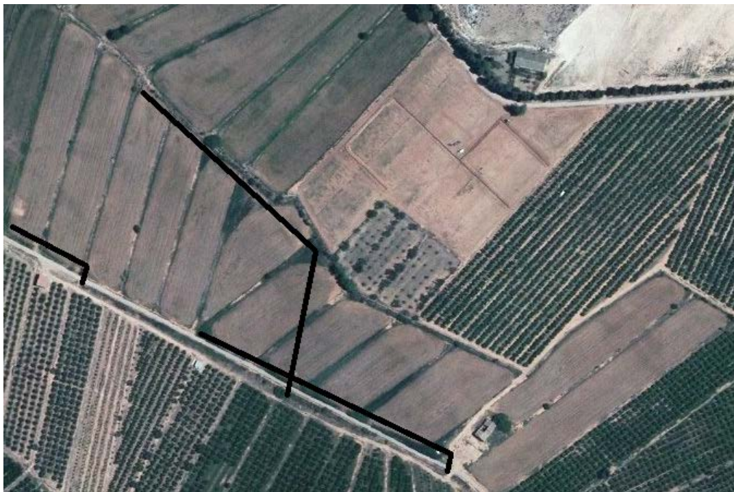
Ilustración 1. Disposición de la red de drenaje en las parcelas objeto de estudio
