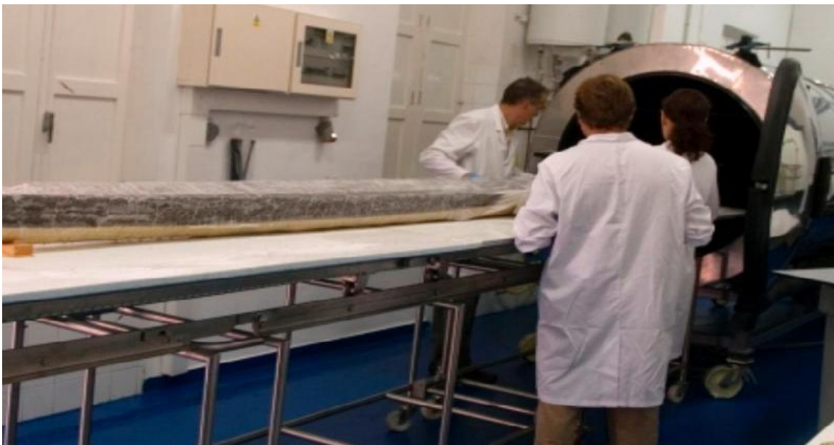
Fig. 33 Liofilizadora del laboratorio de maderas del ARQVA que cuenta con la segunda liofilizadora más grande de Europa. (Foto: Archivo ARQUA)
