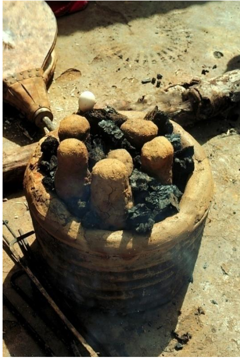
Fig. 13. Moldes colocados en el homo. Proceso de la fundición a la cera perdida. Buoyem, Brong Ahafo, Ghana, 1980. Fotografía: Raymond Silverman. Fuente: Web The University of Iowa Museum of Art, akan Brass Casting, pp. 18.
