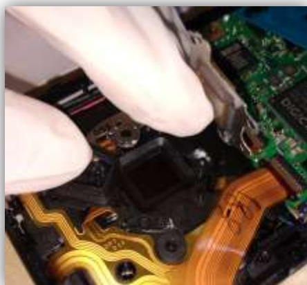
Imagen 23: Extracción de IR-Cut e instalación de filtro IR Wratten 87. Fuente propia.
