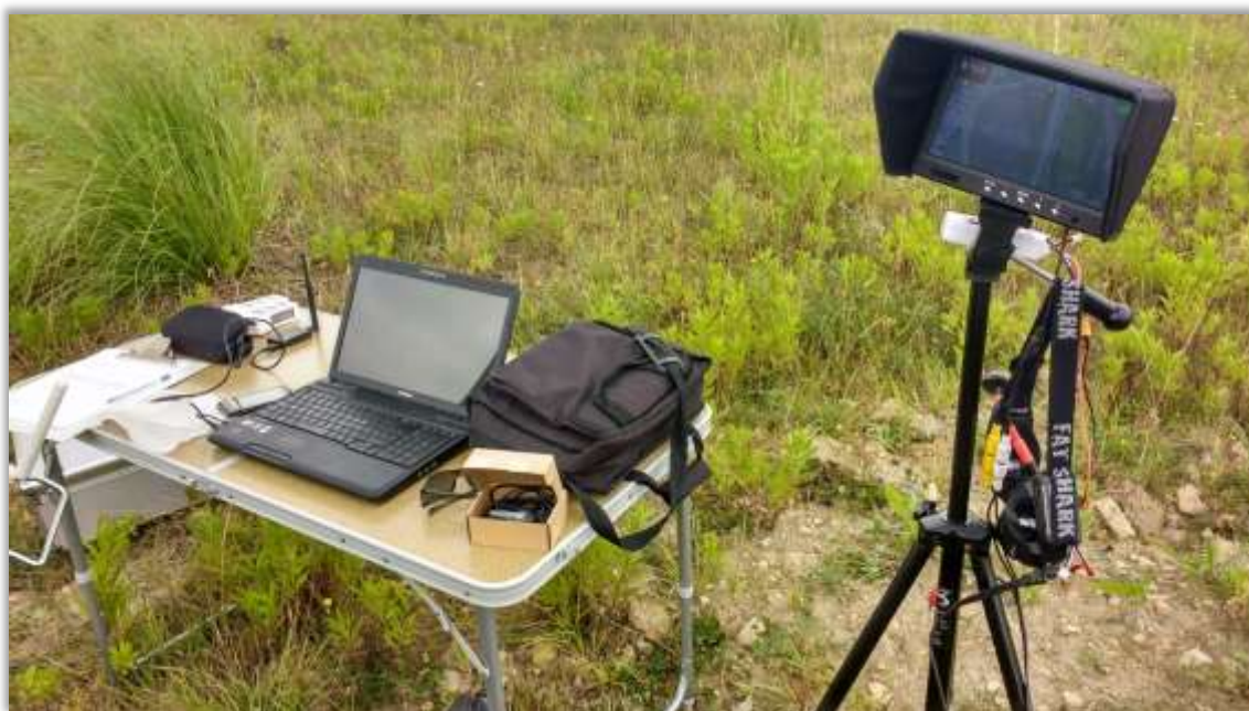
Imagen 10: Disposición de equipo de campo: PC, pantalla y gafas FPV. Elaboración propia.
