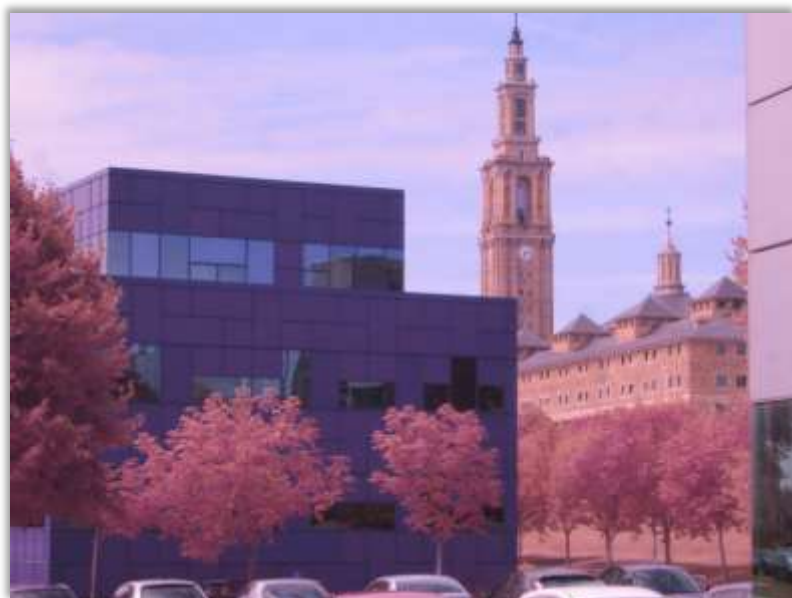
Imagen 24: Captura con cámara sin IR-Cut. Fuente propia.
