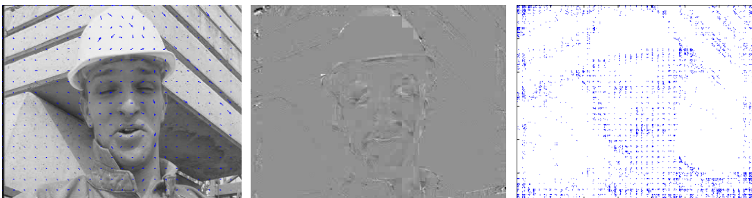
Figura 12 – Vectores de movimiento, residuo y residuo transformado. Nótese que el residuo transformado genera menos coeficientes no nulos que sin predicción temporal (Figura 8).
