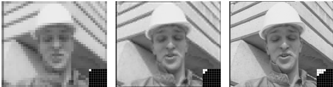
Figura 10 – Calidad del resultado según el número de coeficientes retenidos, indicado en la esquina inferior derecha.
