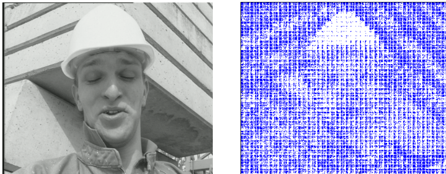
Figura 8 – Imagen original (izquierda) y coeficientes DCT retenidos para su reconstrucción (derecha).
