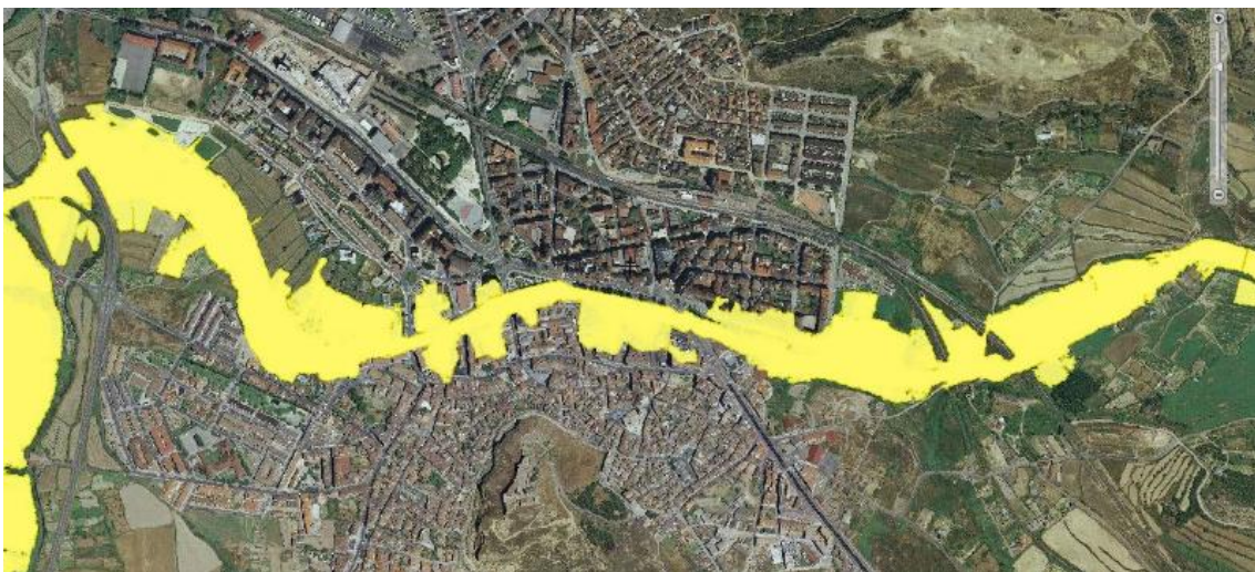
Figura 36. Mapa de peligrosidad y riesgos de inundación (periodo de recurrencia de 500 años)
