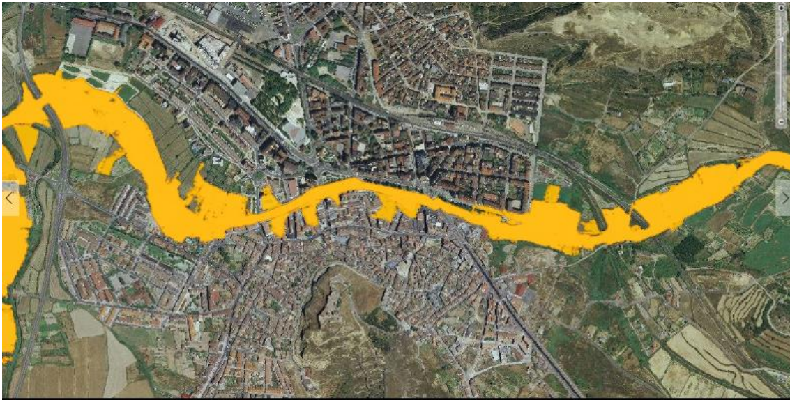
Figura 35. Mapa de peligrosidad y riesgos de inundación (periodo de recurrencia de 100 años)
