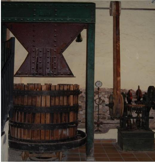
Figura 23: prensa horizontal de maquinaria hidráulica antigua. Fuente: elaboración propia.
