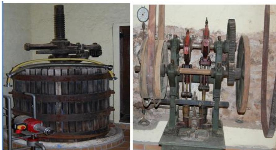
Figura 22: prensa horizontal de tornillo antigua y a la derecha estrujadora. Fuente: elaboración propia
