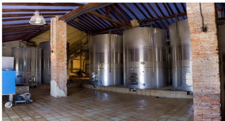
Figura 17: depósitos de acero inoxidable de la bodega. Fuente: elaboración propia
