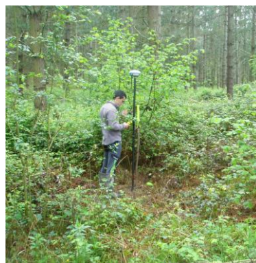
Figura 11: Toma de coordenadas con GPS centimétrico en el centro de la parcela nº 175 del IFN4 en Álava. Fuente: elaboración propia.
