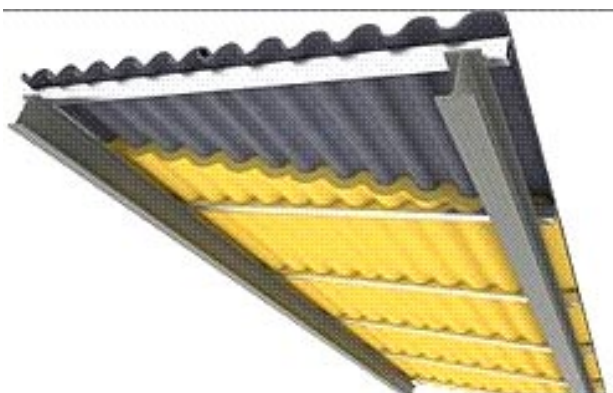
Imagen 11. Ejemplo de cubierta de placa de fibrocemento con espuma de poliuretano proyectada a modo de aislante.
