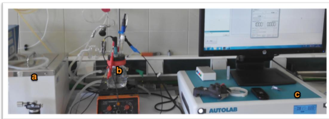
Figura 7. Equipo utilizado para realizar las mediciones electroquímicas de oxidación de metanol y CO.
