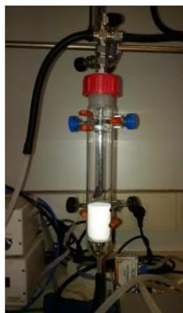
**Figura 3.** Imagen de un lecho fluidizado de esferas de vidrio cubiertas con NPs de sílice.
