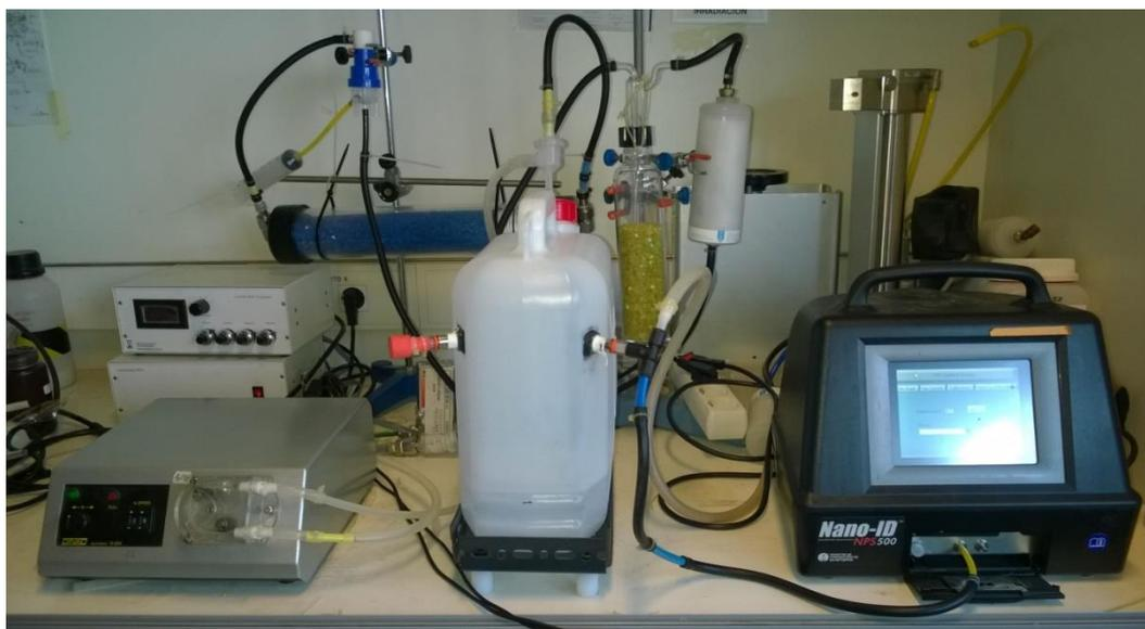
**Figura A6.** Foto general de la instalación experimental completa empleada para la realización de los ensayos de captura.
