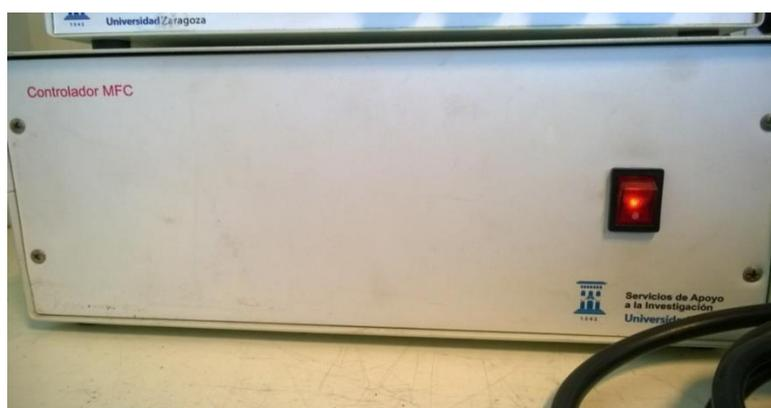
**Figura A7.** Foto del controlador de flujo másico para gases (CFM).
