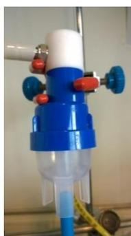
**Figura 2.** Imagen del nebulizador PHILIPS Side Stream<sup>®</sup> jet nebulizer empleado para la obtención de aerosoles nanoparticulados por vía húmeda.
