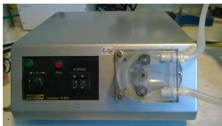
**Figura A12.** Foto de la bomba peristáltica empleada para recircular el agua desde el tanque de ensayos hasta la entrada del sistema de captura tipo "jet mixer".
