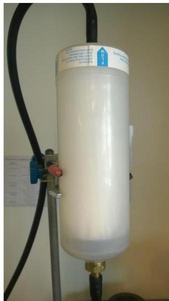
**Figura A9.** Foto del filtro HEPA empleado para filtrar la corriente de entrada de aire al sistema de generación de aerosoles.
