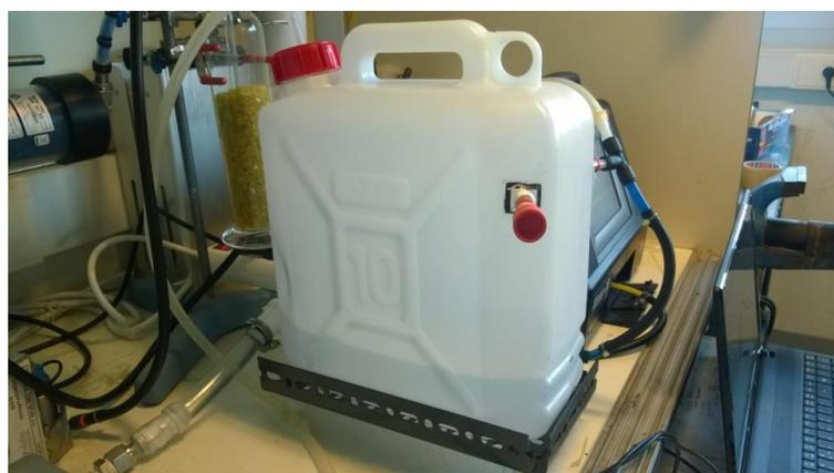
**Figura A11.** Tanque donde dispersa el aerosol generado y se mide la concentración de número de partículas y las distribuciones de tamaño.
