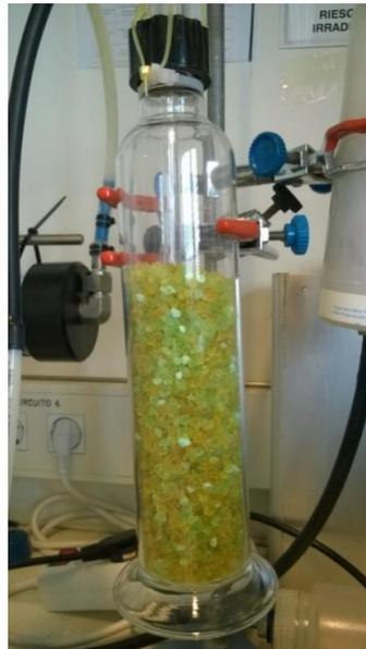
**Figura A8.** Foto del desecador de aire para acondicionar la corriente de entrada de aire al sistema de generación de aerosoles (contiene gel de sílice).
