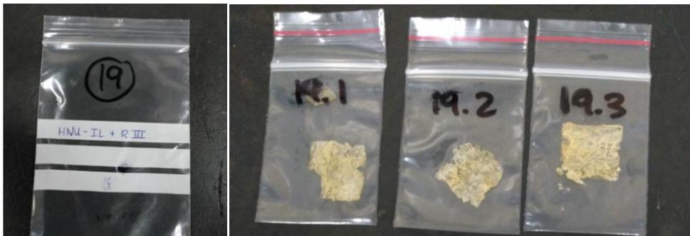
**Figura 68** Piezas obtenidas de la mezcla R.III + IL 5 %
