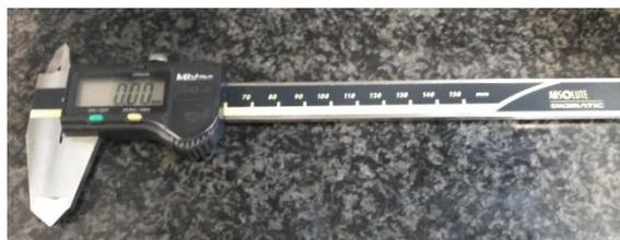
**Figura 17** Fotografía del pie de rey utilizado para medir espesores
