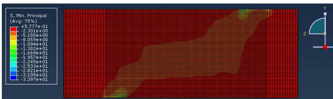
Figura 73. Biela de compresión formada en el hormigón
