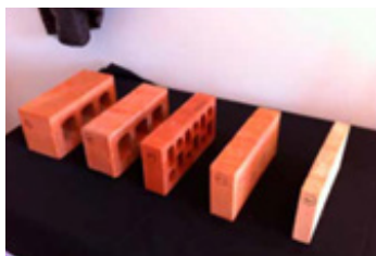
F36. Gama de bloques cerámicos utilizados para configurar el diseño de
