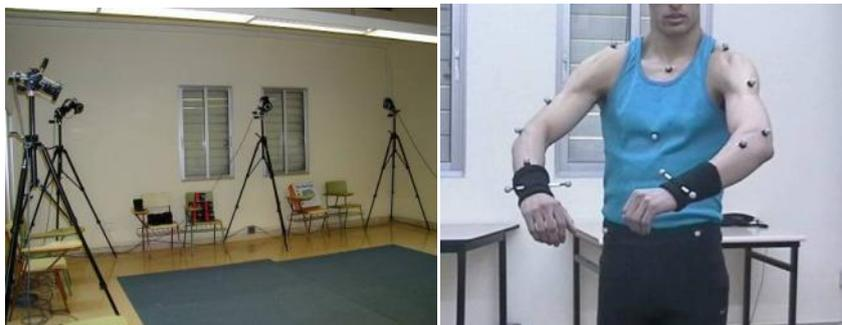
Fig. 2.17. Sistema VICON. Colocación de Marcadores. Detalle de cámaras.
