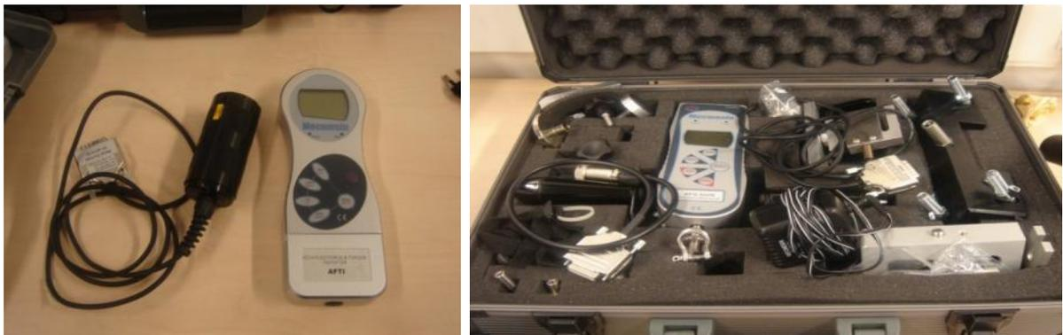
Fig. 8.2. Dinamómetro digital y torquímetro. Accesorios útiles en campo.
