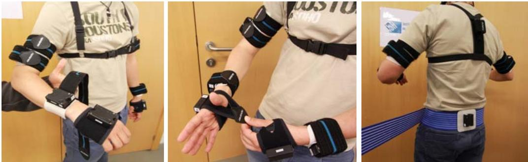
Fig. 2.18. Sensores inerciales y su posible colocación en el cuerpo.
