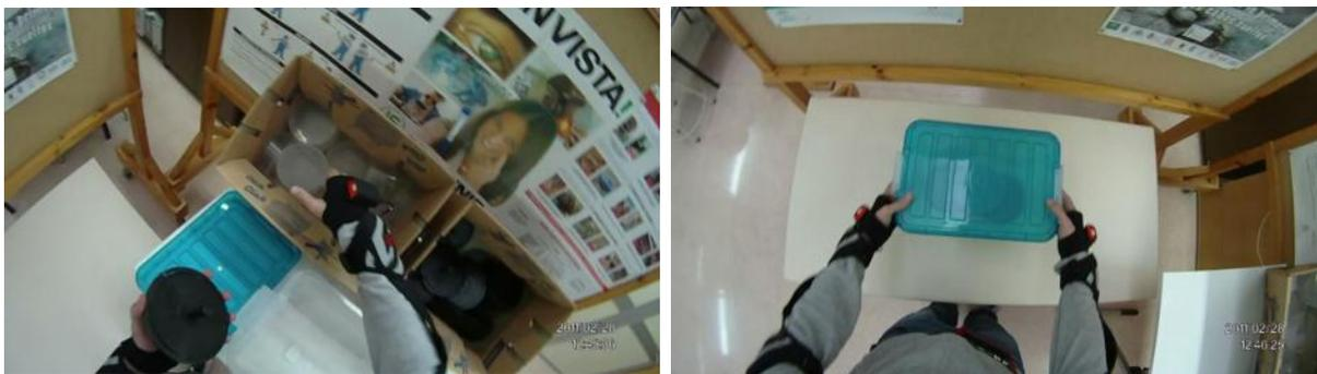
Fig. 7.14. Visualización de cámara panorámica ubica sobre el casco. Puesto de trabajo simulado.
