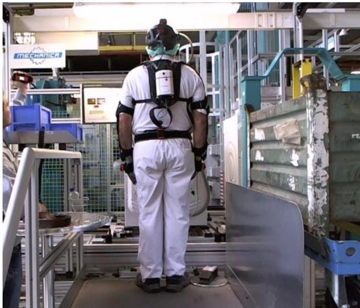
Fig. 8.5. Trabajador con el Sistema MH Sensors (9 sensores) en el puesto de trabajo.
