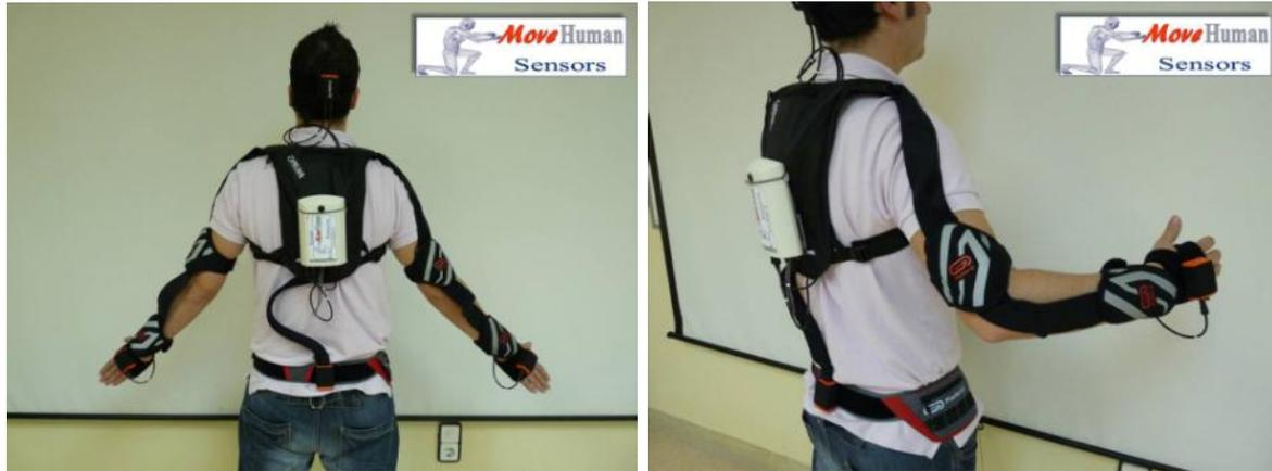
Fig. 7.13. Sensores Inerciales de Movimiento, Concentrador y Colocación.
