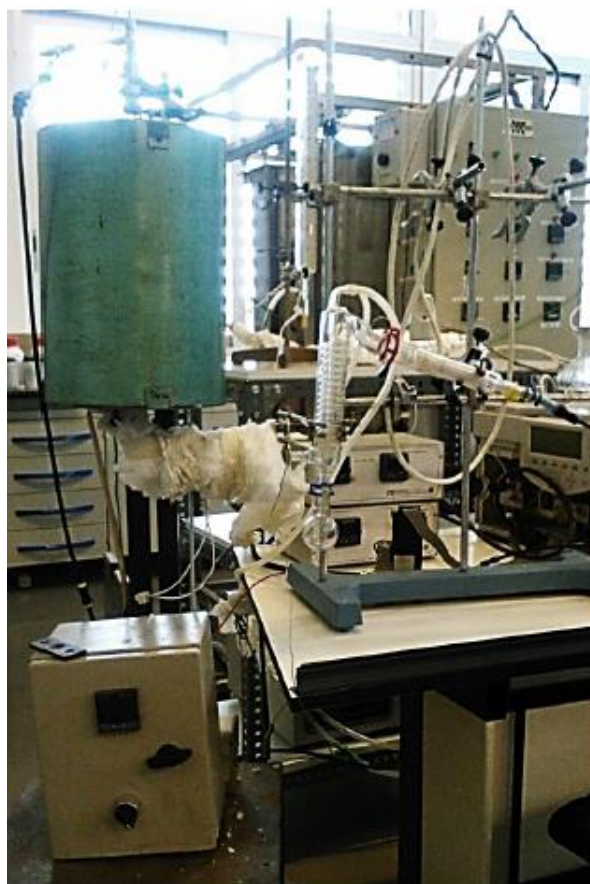
Figura I- 10. Sistema experimental empleado en los experimentos de pirólisis.
