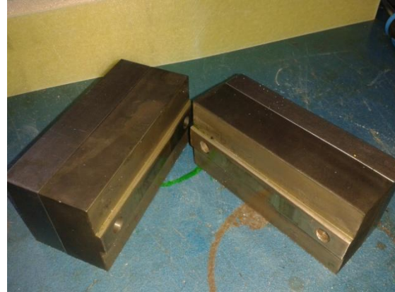
Figuras 26 y 27. Mordazas de pisado de materiales F521 (izquierda) y AMPCO 25 (derecha).
