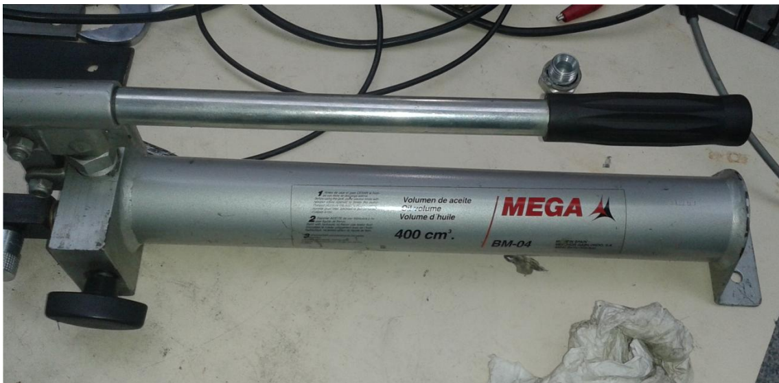
Figura 28. Imagen de la bomba manual de aceite con la que se acciona el cilindro de pisado.
