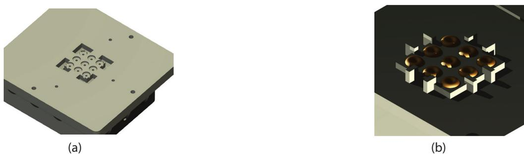
Figura 31 – Cambio alojamientos posicionadores (a) Prototipo fase 1 (b) Diseño inicial
