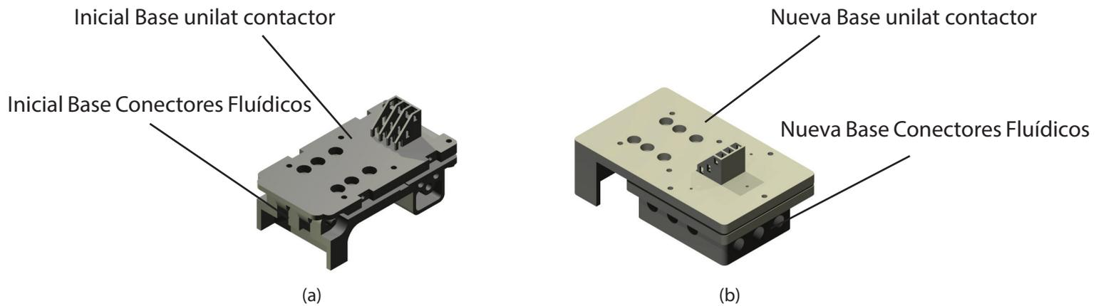
Los cambios se centran en la redistribución de los conductos en las tres superficies más accesibles de la pieza Base Conectores Fluídicos, se organizan destinando las entradas a sus salidas más próximas e intuitivas para el usuario, tal y como se ve en la Figura 25.
