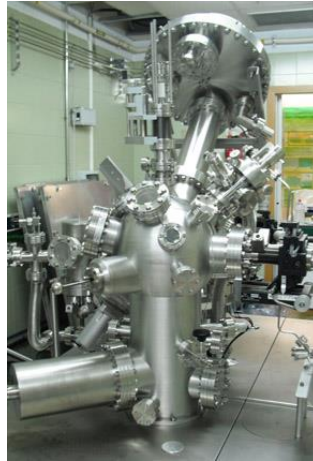
Figura 11. Espectrómetro fotoelectrónico de Rayos X ESCA+ (Omicron) [25].
