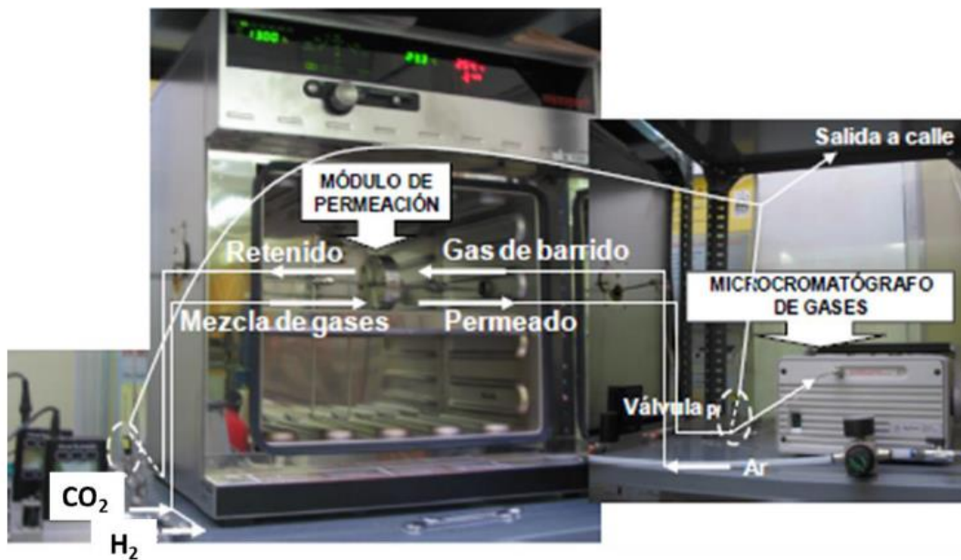
Figura 8 Planta de separación de gases.
