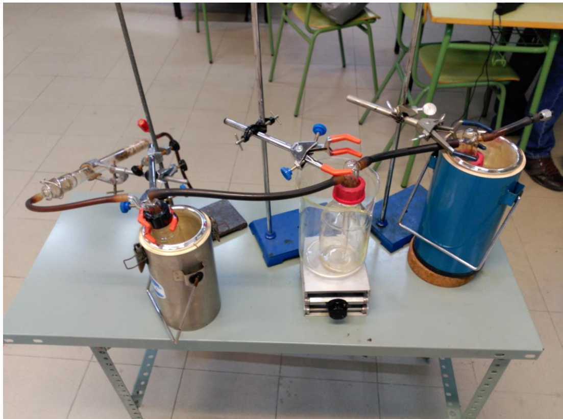
Figura I.7 Sistema de condensación para volátiles
