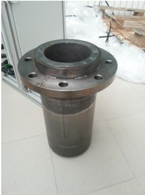
Figura I.1 Reactor de alta presión y temperatura.
