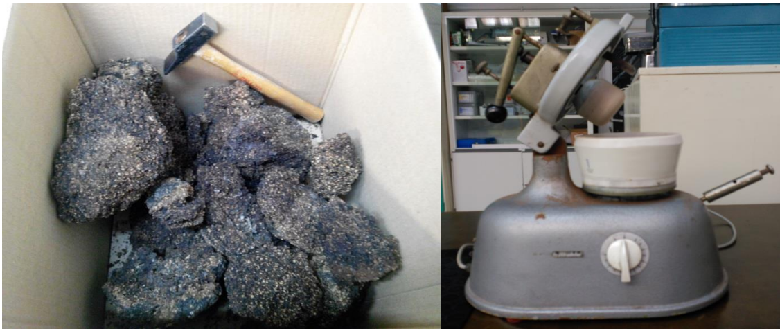
Figura 4.1 Alperujo recibido y molino tipo mortero
