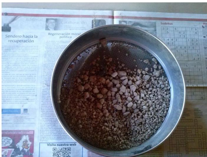
**Fig.11:** Tamizado de las muestras de suelos
