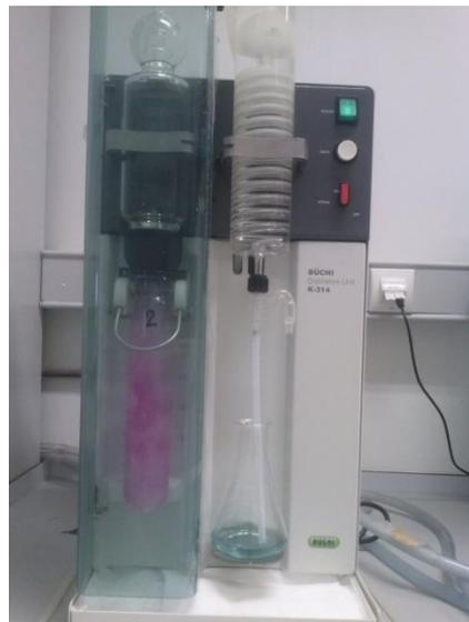
**Fig. 18:** Proceso de destilación del amonio a través de un destilador Kjeldahl.
