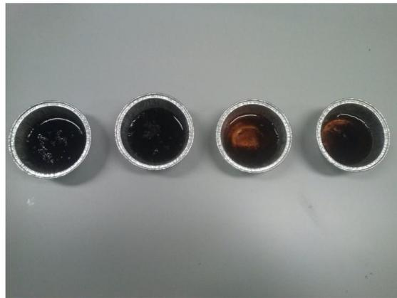
**Fig. 13:** Inmersión de los agregados en pirofosfato durante su la determinación de su Estabilidad Estructural
