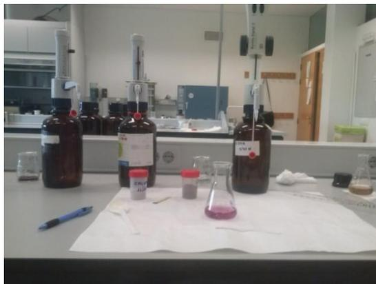
**Fig. 21:** Proceso de determinación de Ca<sup>++</sup> por valoración con EDTA
