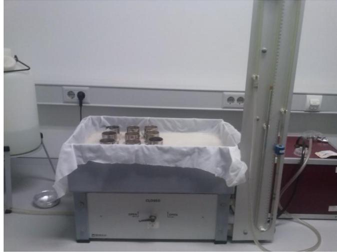
**Fig. 16:** Muestras preparadas para iniciar el proceso de succión con caolín.
