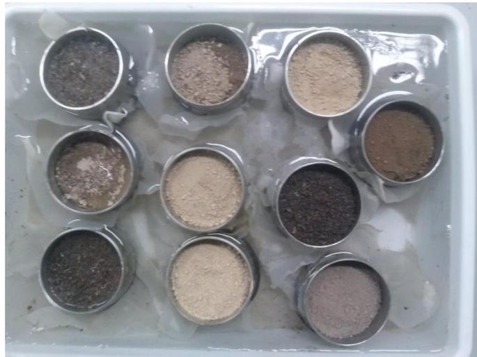
**Fig. 15:** Cilindros en proceso de humectación.
