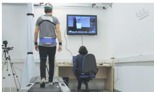
Figura 2: Análisis de la marcha sobre tapiz rodante con sensores ópticos, grupo ID Ergo.
