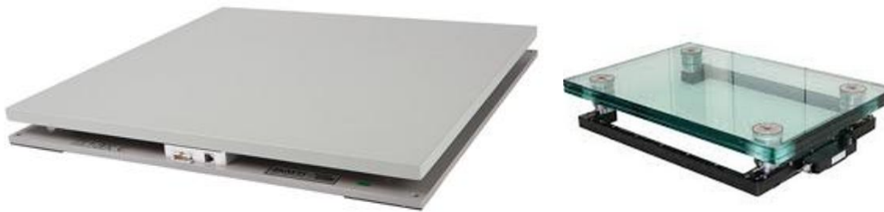
Figura 8: Plataformas dinamométricas creadas por las empresas AMTI y KISTLER.
