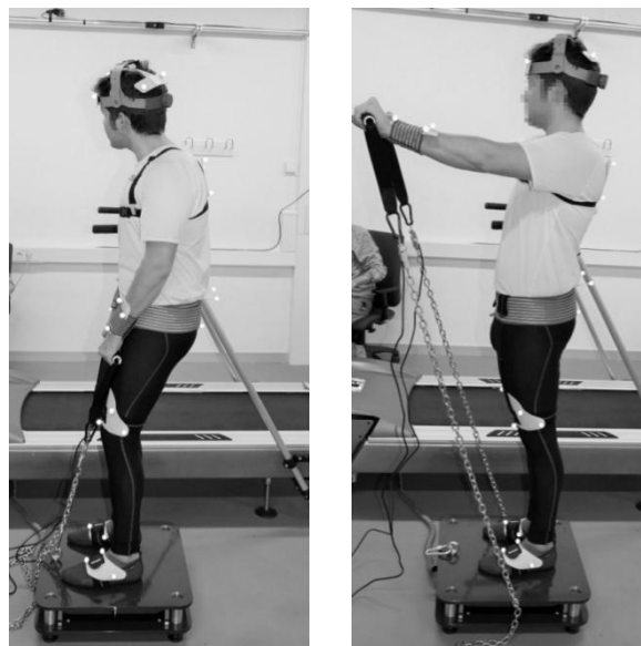
Figura 43: Prueba de dinamometría lumbar + hombros con sensores ópticos.
