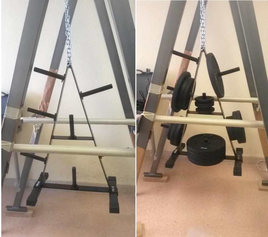
Figura 72: Soporte discos olímpicos. Con carga y sin carga.
